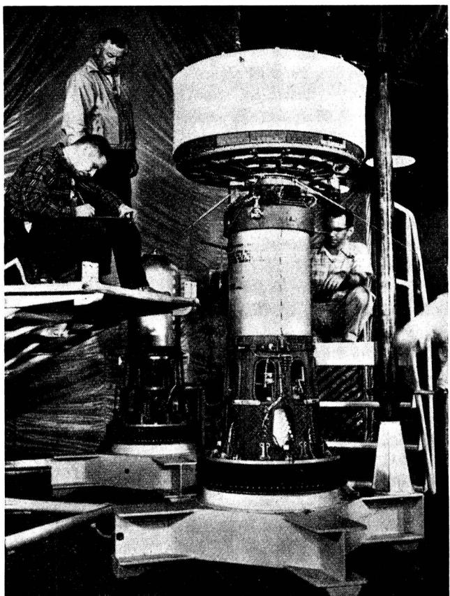
*Tiros I* auf der Endstufe der dreistufigen Thor-Able-Rakete. Die Photozellen zur Energieversorgung sind durch ein Tuch abgedeckt.
