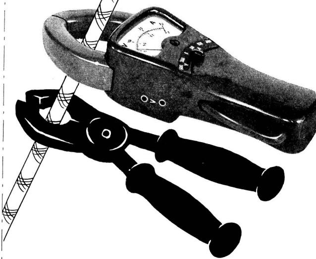
kann mühelos mit einer Zange durchgezwickt werden. Der Zangenstrommesser sieht so ähnlich aus und leistet ebenso mühelos gute Dienste. Ströme bis 600 A werden mit dem kleinen Instrument spielend leicht gemessen. Dies ist gar nicht so schwer zu verstehen und rasch erklärt.
