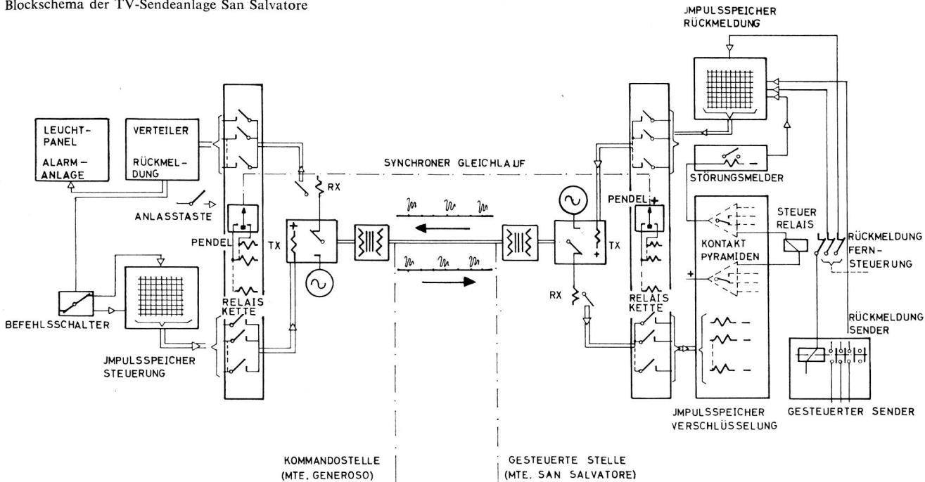
chron schwingenden Pendel, die als Taktgeber den Ablauf der zugeordneten Relaisketten steuern.
