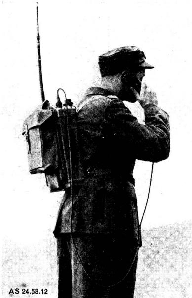
Das Kleinfunkgerät wird auf dem Rücken getragen und erlaubt den Funkverkehr während des Marsches sowie in liegender Stellung in Deckung. Mit Hilfe der Spreizfüsse kann das Gerät auch auf dem Boden aufgestellt werden.
