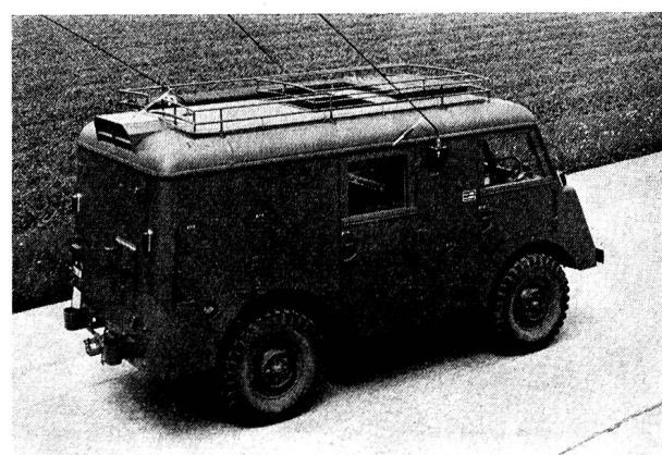
Die Funkanlage kann im Kdo.-Fahrzeug Mowag 1 T 4x4 eingebaut werden. Letzteres weist eine
