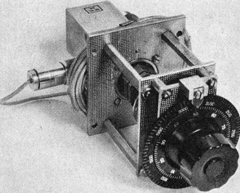
Die Antennenfilter haben genauen Gleichlauf und werden durch einen Drehknopf mit frequenzgeeichter Skala eingestellt
