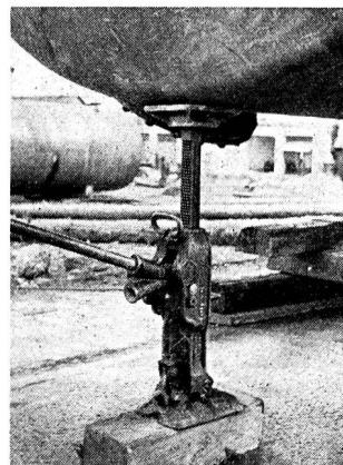
**SIMPLEX-Universalwinden No. 522 und 2030 sowie CM Puller sind Standardausrüstung der LS- und Genietruppe.**
