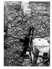
SIMPLEX-Winden sind sehr sparsam im Gebrauch, da praktisch kein Verschleiss; eine Anschaffung reicht für 1-2 Generationen. Die SIMPLEX-Universalwinden sind die einzigen Winden des Weltmarktes, die ein Einstückganzstahlrippengehäuse und eine bewegliche Fundamentplatte mit Rippen besitzen. Ihr Gehäuse weist weder Bolzen, Schrauben, Muttern, Nieten, Stifte noch Schweissnähte auf.
