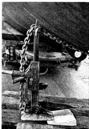
**SIMPLEX-Winden sind sehr sparsam im Gebrauch, da praktisch kein Verschleiss; eine Anschaffung reicht für 1-2 Generationen. Die SIMPLEX-Universalwinden sind die einzigen Winden des Weltmarktes, die ein Einstückganzstahlrippengehäuse und eine bewegliche Fundamentplatte mit Rippen besitzen. Ihr Gehäuse weist weder Bolzen, Schrauben, Muttern, Nieten, Stifte noch Schweißnähte auf.**
