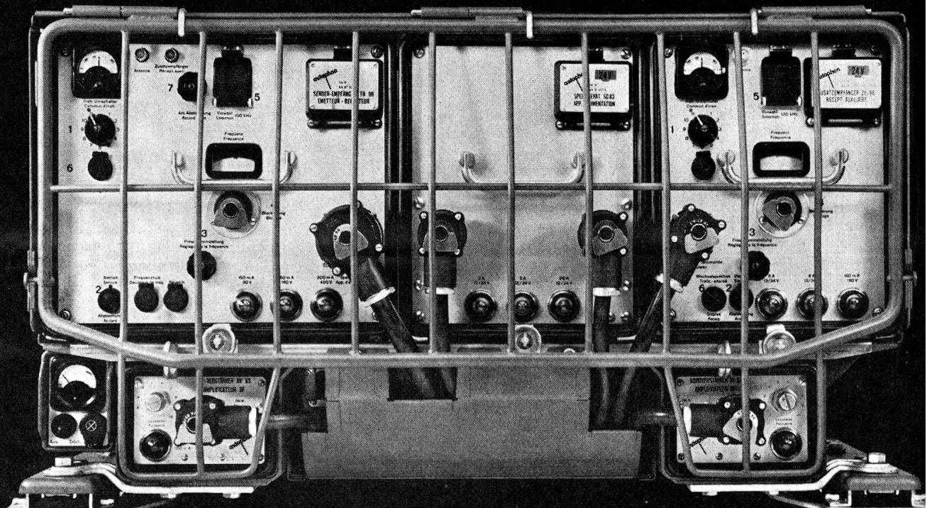
Die Funkstation SE 407, von der Autophon AG für die Schweizer Armee entwickelt, ist für den Einsatz in Panzern, Kdo-Fahrzeugen, Werkstattwagen usw. gebaut. Sender-Empfänger und Zusatzempfänger sind je für mehr als 100 Kanäle ausgerüstet, von denen sich mehrere vorabstimmen und über das Bedienungsgerät fernauswählen lassen. Speisung aus der Fahrzeugbatterie. Die Anlage ist robust und betriebssicher konzipiert, sie wird im Wechsel- oder Gegensprechverkehr und als Relaisstation eingesetzt.
