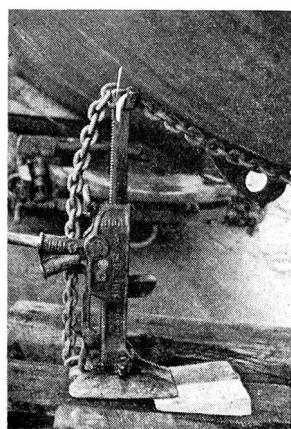
**SIMPLEX-Winden sind sehr sparsam im Gebrauch, da praktisch kein Verschleiss; eine Anschaffung reicht für 1-2 Generationen.** Die **SIMPLEX-Universalwinden** sind die einzigen Winden des Weltmarktes, die ein **Einstückganzstahlrippengehäuse** und eine **bewegliche Fundamentplatte mit Rippen** besitzen. Ihr **Gehäuse weist weder Bolzen, Schrauben, Muttern, Nieten, Stifte noch Schweißnähte auf.**
