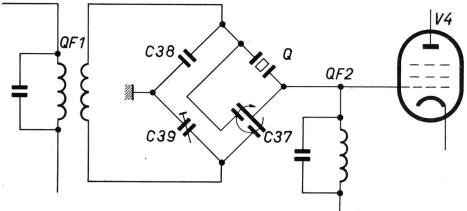
Fig. 6. Prinzipschaltung für Quarzfilterbrücke
