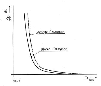
In der Regel wird das Diagramm nach Fig. 4 mit logarithmischer Teilung für die Feldstärke gezeichnet. Anderseits aber ändern die Empfindungen aller menschlichen Sinnesorgane, also auch des Gehörs, annähernd mit dem Logarithmus des einfallenden Signals. Abgesehen vom Maßstabe müsste somit, bei linearer Teilung der Ordinatenachse und Auftragen der subjektiv empfundenen Hörbarkeiten, grundsätzlich dasselbe Bild entstehen.
