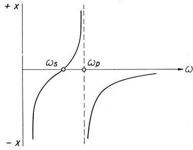
Fig. 2. Blindwiderstandsverlauf des piezoelektrischen Resonators.
