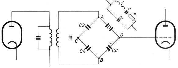
Fig. 3. Prinzipschema der Quarzbrückenschaltung.
