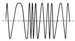
Fig. 5. Hochfrequenter Träger mit Frequenz-Modulation.
