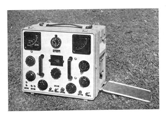
Fig. 12. Kombinierte Sende-/Empfangsapparatur der Einseitenbandfunkstation SE 222.
