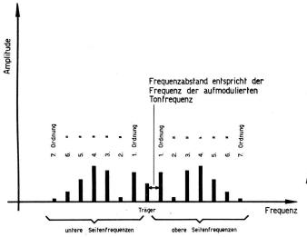
Fig. 7. Frequenz-Spektrum bei Frequenz-Modulation.
