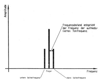
Fig. 6. Frequenz-Spektrum bei Amplituden-Modulation.
