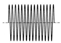
Fig. 4. Unmodulierter hochfrequenter Träger.
