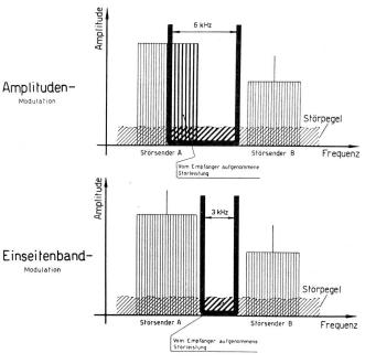
Fig. 9. Empfänger-Selektivität mit zwei Störsendern.
