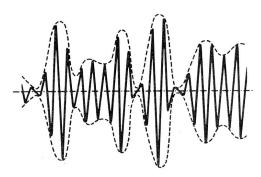
Fig. 3. Hochfrequenter Träger mit Amplituden-Modulation.
