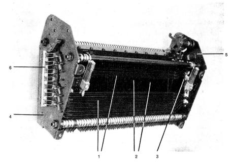
Fig. 16. Tastatur von unten. 1 14 Elementarzeichenschienen, schwenkbar gelagert — 2 Schriftzeichenschienen (für jede Taste eine separate Schiene) — 3 Lagerstellen der Elementarzeichenschienen — 4 Linke Seitenplatine — 5 Rechte Seitenplatine — 6 7 Elementarzeichenkontakte.
