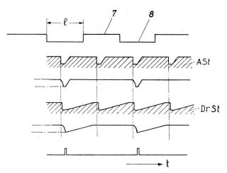
Fig. 12. Zeitplan des Druckwerkes. 1 Impulsprogramm (Kombination) — 2 Ankersteuerscheibe — 3 Ankerbewegung — 4 Drucksteuerscheibe — 5 Druckhebel — 6 Type — 7 Stromschritt — 8 Stromlücke — I Länge des Einheitsschrittes.
