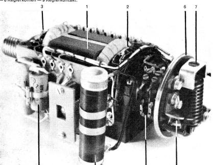
An der linken Seitenplatine 4 sind sieben der vierzehn Elementarzeichenkontakte 6 befestigt, die anderen sieben befinden sich auf der gegenüberliegenden Platine 5.
