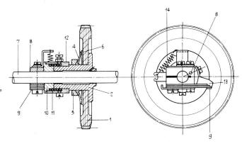
Fig. 7. Federkupplung. 1 Antriebsrad — 2 Laufbüchse — 4 Feder — 5 Stellring — 6 Zwischenring — 7 Steuerwelle — 8 Klemmstück — 9 Stopnase — 10 Büchse — 11 Kupplungsfeder — 12 Lösezylinder — 13 Lösenase — 14 Feder
