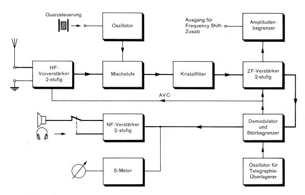
Fig. 2 Blockschema des Empfängers E-627
