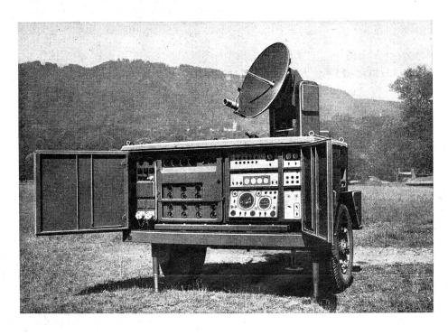
Der ALBIS-Feuerleitradar AF 406 bildet zusammen mit der Rechner und dem Richtgeri der Firma Contraves AG. Züric das Feuerleitgerät für Mitte kaliber - Fliegerabwehr — ei in enger Zusammenarbeit de beiden Firmen entstandene Produkt schweizerischer Qualitätsarbeit.
