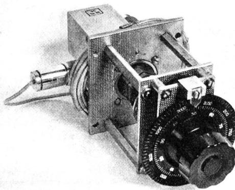
Die Antennenfilter haben genauen Gleichlauf und werden durch einen Drehknopf mit frequenzgeeiachter Skala eingestellt
