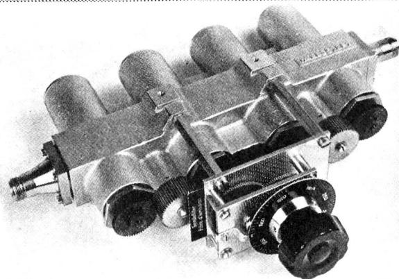
Die einzelnen Chassis sind ohne elektrische Nachregulierung leicht austauschbar • Bewährte Spezialstecker sichern einwandfreie Kontaktgabe
