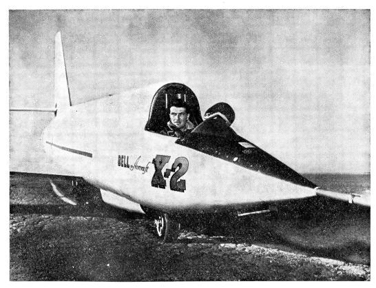
Der «Bell X-2» der amerikanischen Luftwaffe, der im Hinblick auf die Durchbrechung der Hitzemauer konstruiert wurde und aus hitzebeständigem Hartstahl und einer Nickellegierung gebaut ist. Die von einem Mutterflugzeug abgehende Maschine erreicht mit ihrem Raketentriebwerk eine Geschwindigkeit von 3040 km in der Stunde. Soeben erfährt man, dass eines dieser Versuchsflugzeuge bei einem Flug in Kalifornien abgestürzt ist
