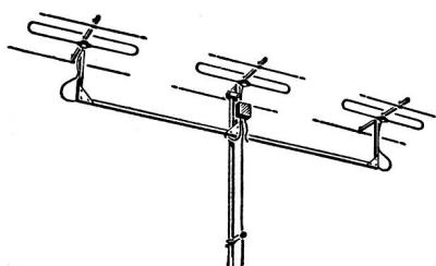
doppelte Spannung zum Empfänger wie von den beiden äusseren. Durch dieses Schaltungsprinzip ergibt sich eine viel günstigere Horizontal-Richtcharakteristik als bei den seither gebräuchlichen Antennen.
