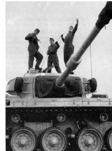
Die Funkantenne wird ausgezogen. Während der Fahrt muss jeder «Centurion» mit den anderen und dem Kommandanten in enger Funkverbindung bleiben. Schweizerische Funkgeräte sind in den englischen «Centurion» eingebaut worden.
