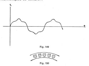
Pour éviter dans toute la mesure du possible ces harmoniques, on a réduit l'ouverture des encoches en les évidant à l'intérieur pour permettre le bobinage (fig. 150).
