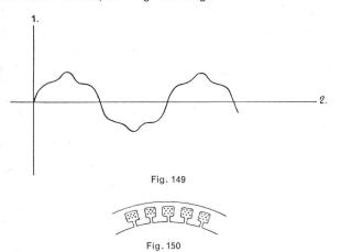
Um diese Verzerrungen zu beseitigen bildet man die Pole an den Enden zu Polschuhen aus (Fig. 150). Durch geeignete Wahl der Polschuhform am Rotor, lässt sich eine ziemlich genaue Sinuscharakteristik erreichen.
