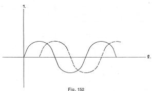
Die Ströme sind um ¼ Periode voneinander verschoben, die Frequenz ist aber bei beiden gleich. Wir haben nun einen zweiphasigen Wechselstromgenerator verwirklicht. Um Drei- oder Mehrphasenströme zu erzeugen, bauen wir im Stator drei oder mehr Spulengruppen ein.
