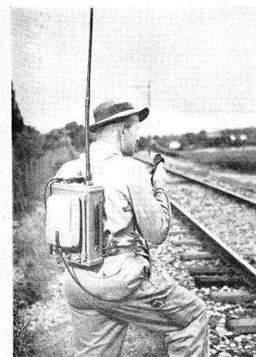
Links: Wo das Legen einer temporären Telefonleitung wenig rationell wäre und doch vorübergehend eine sichere Sprechverbindung wünschbar ist, hilft das Tornistertelephon ohne jeden Umtrieb. Zum Beispiel auf umfangreichen Baustellen, beim Kabelzug im unübersichtlichen Gelände, während Umleitungen auf Verkehrswegen usw. — Man spricht dabei genau gleich wie am Telefon, das Gerät lässt sich ohne Vorkenntnisse von jedermann bedienen.
