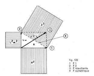
**Remarque I:** Dans le cas ci-dessus, appelons le vecteur  $F_2$ , résistance apparente d'une self ou encore  $L\omega$ , et le vecteur  $F_1$  résistance ohmique pure de la self; la résultante sera l'impédance Z.
