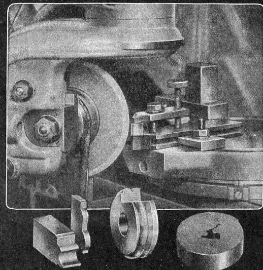
zum Schleifen von Profil-Lehren, flachen und runden Profilstählen, mehrteiligen Matrizen usw.
