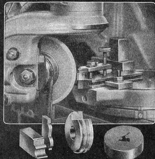
zum Schleifen von Profil-Lehren, flachen und runden Profilstählen, mehrteiligen Matrizen usw.
