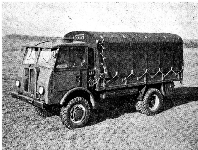
Abb. 3 Geländelastwagen 5 t — 4x4, Saurer Dieselmotor, Nutzlast 5 t
