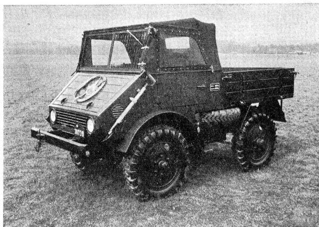
Abb. 1 UNIMOG Mercedes-Dieselmotor, Nutzlast 1,1 t, 6 Vorwärts- und 2 Rückwärtsgänge
