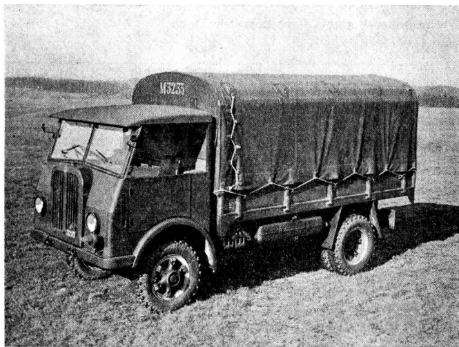
Abb. 2 Geländelastwagen 3 1/2 t — 4x4, Saurer Dieselmotor, Nutzlast 3 1/2 t
