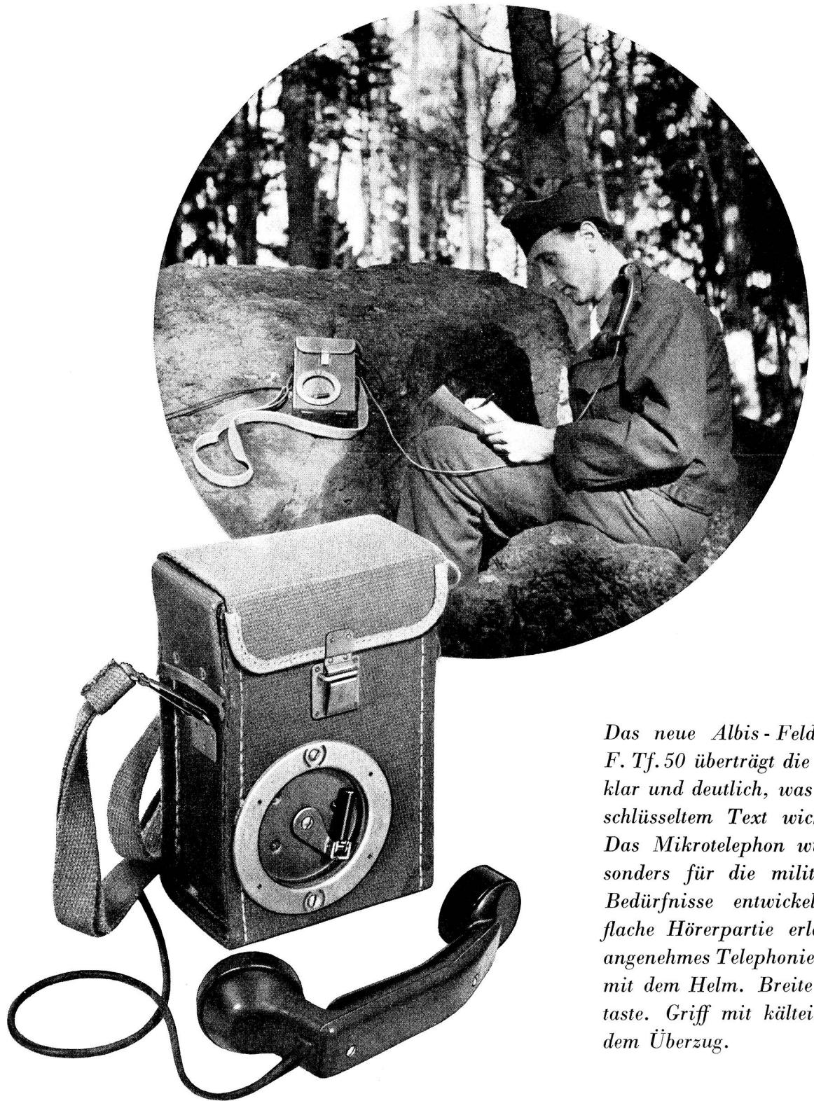
*Das neue Albis - Feldtelephon F. Tf. 50 überträgt die Sprache klar und deutlich, was bei verschlüsseltem Text wichtig ist. Das Mikrotelephon wurde besonders für die militärischen Bedürfnisse entwickelt: Die flache Hörerpartie erlaubt ein angenehmes Telefonieren auch mit dem Helm. Breite Sprech-taste. Griff mit kälteisolierendem Überzug.*
