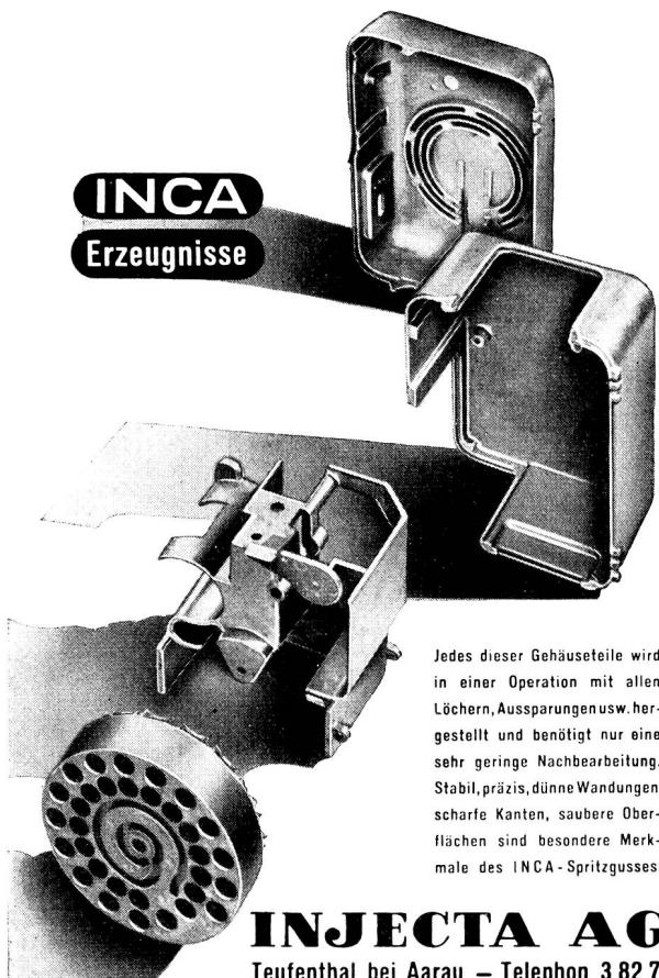
Jedes dieser Gehäuseteile wird in einer Operation mit allen Löchern, Aussparungen usw. hergestellt und benötigt nur eine sehr geringe Nachbearbeitung. Stabil, präzis, dünne Wandungen, scharfe Kanten, saubere Oberflächen sind besondere Merkmale des INCA-Spritzgusses.
