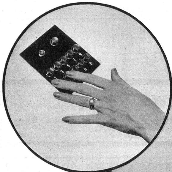
Das Herz der schnurlosen Vermittlungseinrichtung ist der Zahlengeber, bei dem an Stelle des Nummerschalters, zum Einstellen der Telefon-Nummern, zehn Drucktasten bedient werden. Die Tasten können dabei in beliebig rascher Reihenfolge gedrückt werden, was besonders das Wählen von vielstelligen Nummern sehr erleichtert.
