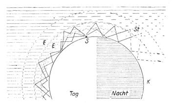
Ionisierung der hohen Atmosphäre durch Sonnenstrahlung und verschiedene Reflexionsmöglichkeiten der Funkwellen an den Schichten der Ionosphäre. S = Sender, E = E-Schicht, St = Streuung, K = Kein Empfang.
