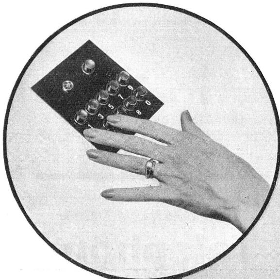
Das Herz der schnurlosen Vermittlungseinrichtung ist der Zahlengeber, bei dem an Stelle des Nummerschalters, zum Einstellen der Telefon-Nummern, zehn Drucktasten bedient werden. Die Tasten können dabei in beliebig rascher Reihenfolge gedrückt werden, was besonders das Wählen von vielsteligen Nummern sehr erleichtert.
