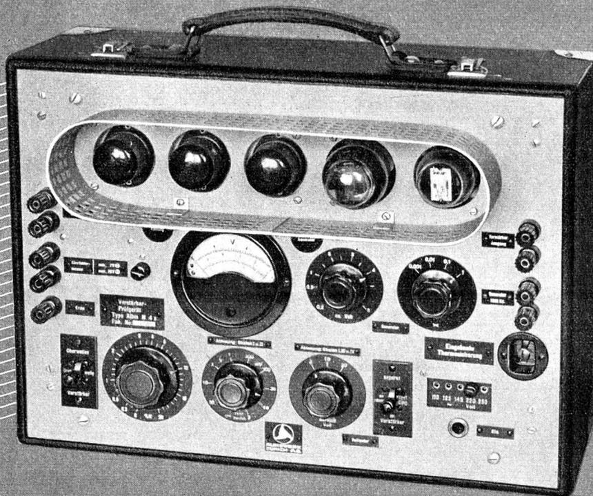
Das Verstärkerprüfgerät dient dazu, Verstärker, die an wichtigen Stellen eingebaut sind, periodisch auf ihren Betriebszustand zu überprüfen. Durch die Überwachung des Klirrfaktors können Alterungserscheinungen an Röhren und Kondensatoren rechtzeitig erkannt und zugleich eingegrenzt werden. Das Prüfgerät besteht im wesentlichen aus einem 1000-Hz-Röhrengenerator, einem Klirrfaktormesser 0,2 - 20%, einem Messverstärker 60 db und einem Tonfrequenz-Voltmeter 30 - 10000 Hz.
