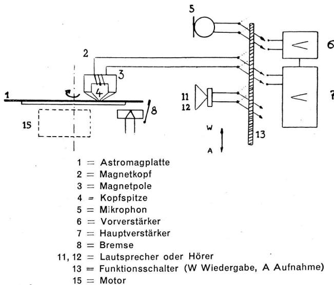
Es ist das Verdienst der Firma Assmann in Bad Homberg, ein Gerät entwickelt zu haben, das endlich den ersehnten Umschwung im mechanischen Diktierwesen bringen wird. Das von dieser Firma gebaute Dimafon vereinigt die Vorteile der Schallplatte mit denjenigen des magnetischen Schallaufzeichnungsverfahrens in geradezu idealer Weise, da die heute jedermann vertraute Handhabung eines Grammophons auch für das Dimafon zutrifft.
