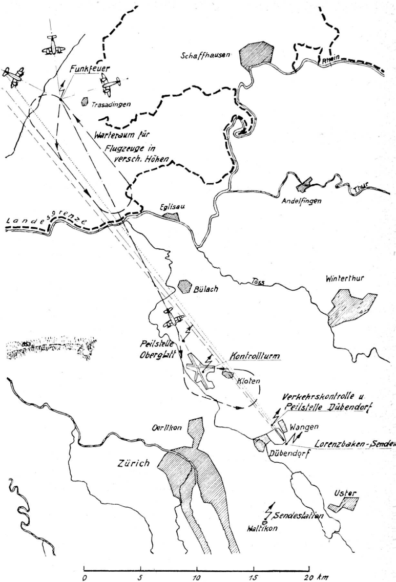
Skizze der Schlechtwetter-Anflugverhältnisse für Kloten - Dübendorf mit den Standorten der verschiedenen Sende- und Empfangsanlagen
