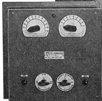
Elektr. Zeitzähleranlagen mit akustischer oder optischer Signalabgabe, zur Meldung von bestimmten Zeitabschnitten
