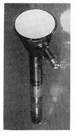
Kathodenstrahlröhre für den Projektionsapparat. Vorne ist der Hochspannungsanschluss für 25 000 Volt sichtbar. Durchmesser des Bildschirmes 62,5 mm, Bildformat 33:44 mm.
