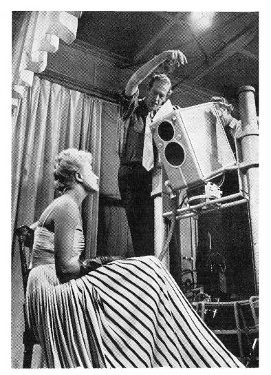
Ein Bild aus dem Fernsehstudio. Die beiden Operateure an der Arbeit mit ihrer Ikonoskop-Aufnahmekamera.
