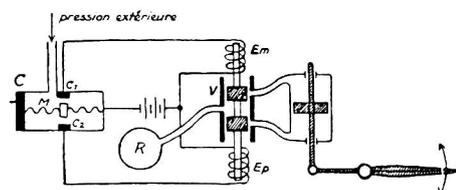
Fig. 10. Pilotage programme altitude ou profondeur constante. — La capsule manométrique C, reliée à l'extérieur, est réglée pour une altitude (avion) ou une profondeur déterminée. Toute variation d'altitude déforme la membrane M et suivant que l'engin est trop haut ou trop bas, l'un des contacts C<sub>1</sub> ou C<sub>2</sub> s'établit. Ces contacts actionnent des relais (ici un relais électropneumatique) qui déclenche l'action du servo-moteur (ici un piston) dans le sens voulu.
