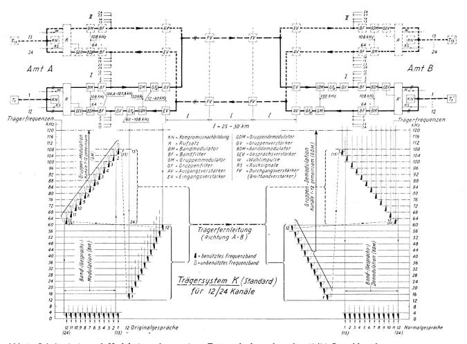
Abb. 3. Schaltprinzip und Modulationsschema einer Trägertelephonanlage für 12/24 Sprechkanäle.
