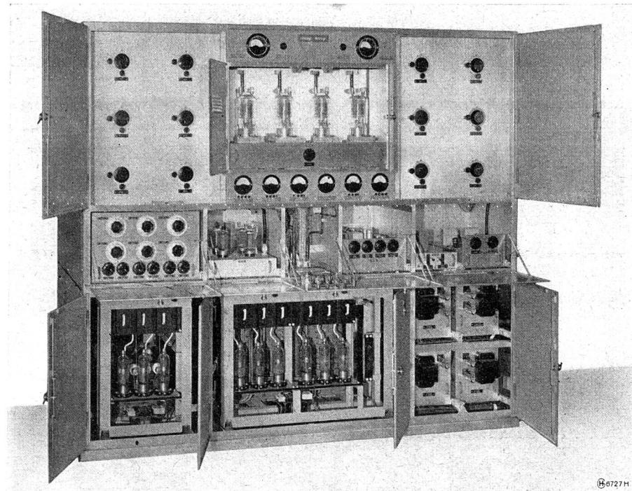
für Mittelwellen ( $100 \div 550$  kHz), wobei durch sehr schnellen Wellenwechsel innert 5 Sekunden eine von 6 verschiedenen, einstellbaren Wellenlängen ausgewählt werden kann. Senderleistung 3 kW für Telegraphie, 1 kW für Telephonie.
