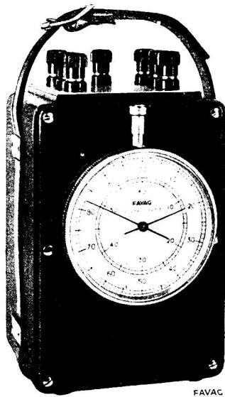
Messgenauigkeit  $\pm 1100$  Sek. Zum Prüfen der Ansprech- und Abfallzeiten von Relais, Schaltapparaten und Eichen von Zeitrelais, Zählern usw.
