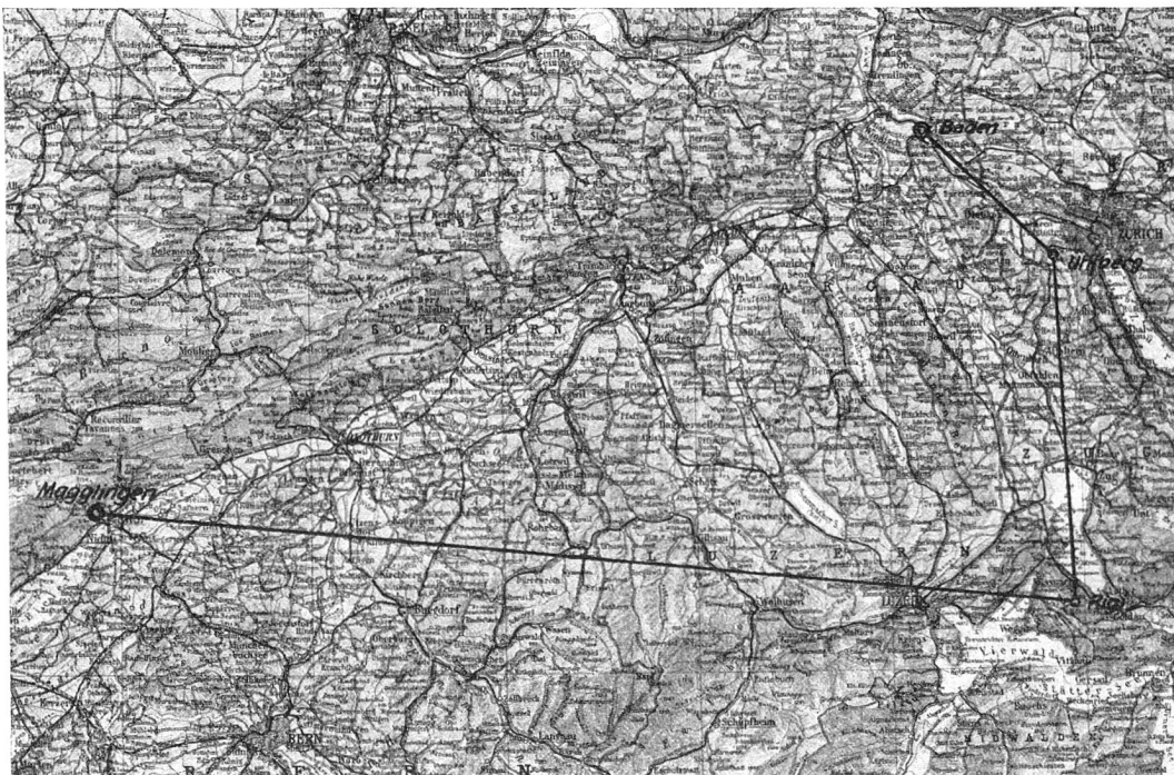
Abb. 1. Versuchsstrecke einer Dezimeterwellen-Richtstrahlverbindung mit zwei Relaisstationen für Telefon-Gegensprechverkehr Baden: Eine Dezimeterstation Rigi-Kulm: Eine Dezimeter-Relaisstation Uetliberg bei Zürich: Eine Dezimeter-Relaisstation Magglingen bei Biel: Eine Dezimeterstation
