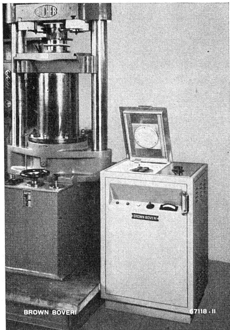
Mit diesem 1-kW-Hochfrequenz-Röhrengenerator wird das in der Kunststoff-Fabrikation verwendete Presspulver in kürzester Zeit durchwärmt und plastisch. Der anschliessende Pressprozess wird abgekürzt und die Produktion gesteigert.
