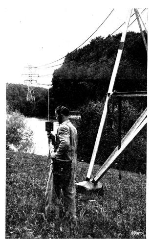
1. HASLER-UKW-Einkanal-Kleingerät, Typ 1940 (UKW = Ultrakurzwellen)
