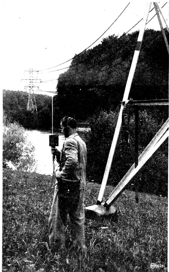
1. HASLER-UKW-Einkanal-Kleingerät, Typ 1940 (UKW = Ultrakurzwellen)
