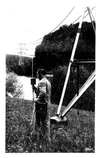
1. HASLER-UKW-Einkanal-Kleingerät, Typ 1940 (UKW = Ultrakurzwellen)
