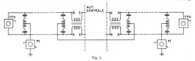
Mit grösserem Erfolg wurde die Schaltung nach Fig. 3 ausprobiert. Die sog. Ueberbrückungsdrossel ist hier nicht als Sperrdrossel im herkömmlichen Sinn eingeschaltet. Ihre Wicklungen werden im Gegenteil so geschaltet, dass sie den Schlaufenstrom sperren und den Simultanstrom durchlassen. Auch die Anzahl der eingeschalteten Kondensatoren ist hier kleiner, als in der Schaltung nach Fig. 2. Die dort geschilderten Gefahren sind dementsprechend reduziert.
