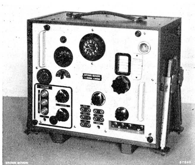
Abb. 1. Tragbares Richtstrahlgerät für sehr kurze Wellen.
