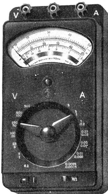
**misst** Wechselströme, Wechselspannungen, Gleichströme, Gleichspannungen und Widerstände
