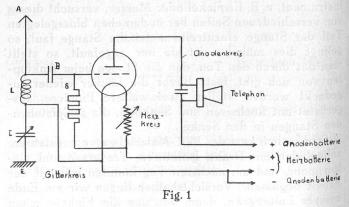
fliesst und sich im Rhythmus der Tonschwingungen ändert. (Ein solcher Hochohmwiderstand besteht aus einem Porzellanröhrchen mit aufgetragener, schwach leitender Schicht.) So entstehen am Gitter Spannungsschwankungen im Takt des gesprochenen Wortes oder
