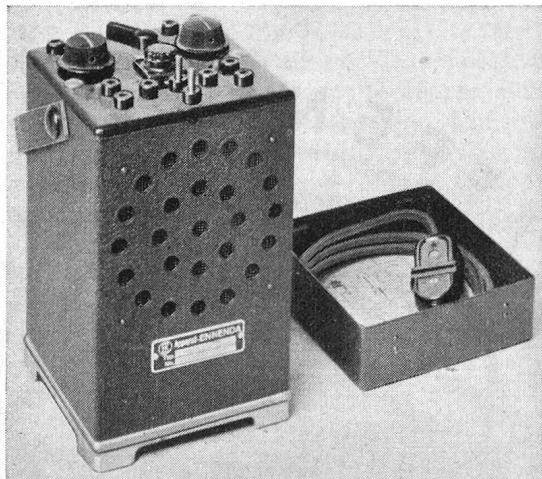
Das neue Morse-Lehrgerät für Netzanschluß 110—230 V ~
