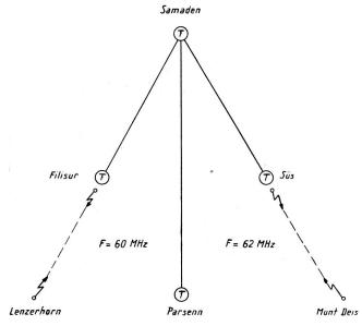
Equipe 2b. Standortbezug bei einem Telephonabonnenten in Filisur, Verbindung mittels UKW-Gerät mit
