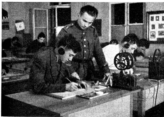
Jungfunker im Theoriesaal. — Im Vordergrund ein Morse-Farbschreiber zur Kontrolle des Tasterspiels
