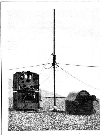
Tragbare leichte Sende-Empfangsstation mit benzinelektr. Aggregat
